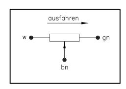
Achtung: Die Abschirmung ist zum Wegaufnehmer-Gehäuse isoliert. Für die Schutzerdung des Gehäuses hat der Anwender geeignete Massnahmen zu treffen.
